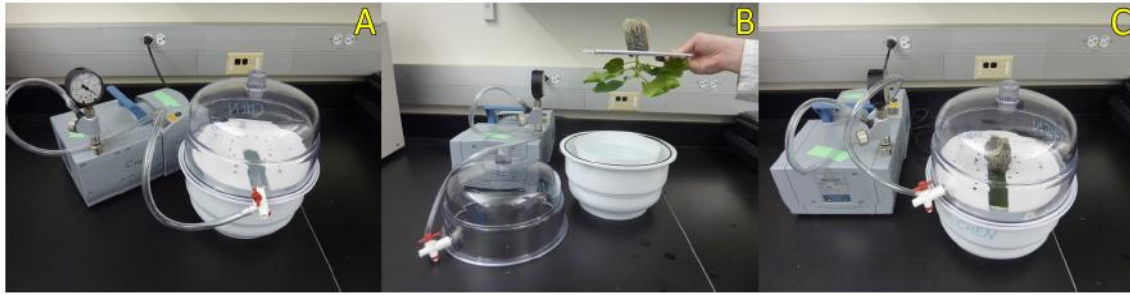
Figure 2 : Infiltration sous vide de feuilles de tabac avec Agrobacterium tumefaciens . Les agrobactéries portant les gènes d'intérêts sont en suspension dans un tampon d'infiltration déposé dans une cuve. Cette dernière est ensuite placée dans un dessiccateur, lui-même connecté à une pompe à vide (A). Un plant de tabac (de 6 semaines) est placé dans dessiccateur (B), de façon à ce que le système foliaire soit immergé dans la suspension bactérienne (C). L'agroinfiltration est obtenue en appliquant le vide dans le dessiccateur (Leuzinger et al., 2013).
